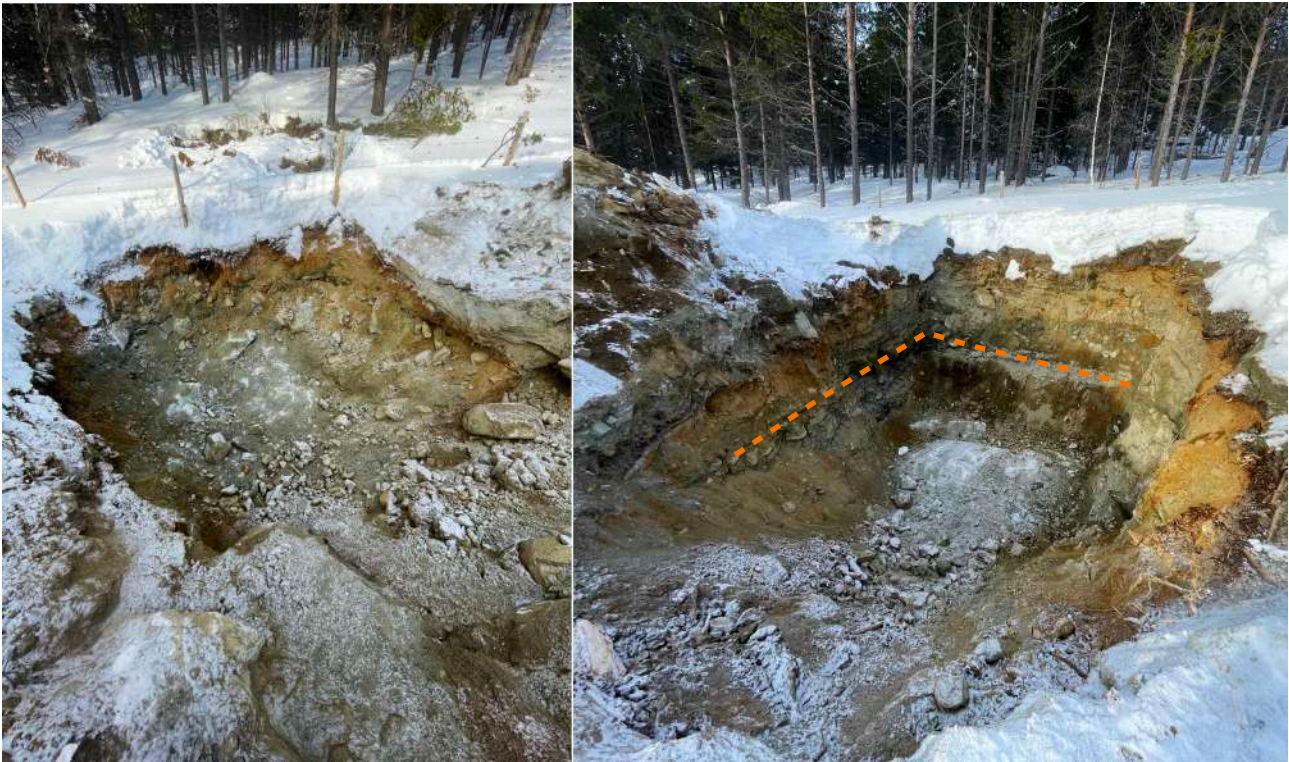
Figur 8. Prøvegraving hull 2 (venstre) og prøvegraving hull 3 (til høyre), se teksten for beskrivelse, i hull 3 er overgangen mellom morene masser og fluviale avsetninger markert med en stiplet oransje linje
