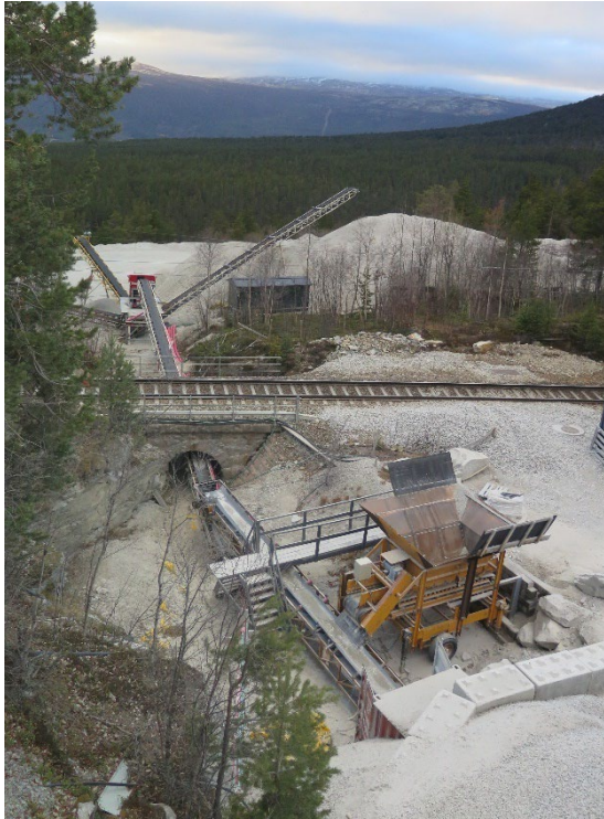
Figur 12: Transportband i tunnel under jernbanen for frakt av massar frå fjelltak til masselagringsplass.
