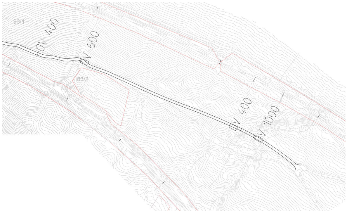
Figur 8 – Eksisterende OV-rør ved tilkomstvei til masselager
